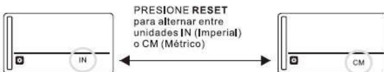
Img 2a. En el modo "SETUP": seleccionar entre unidades IN (Imperial) o CM (Métrico)
